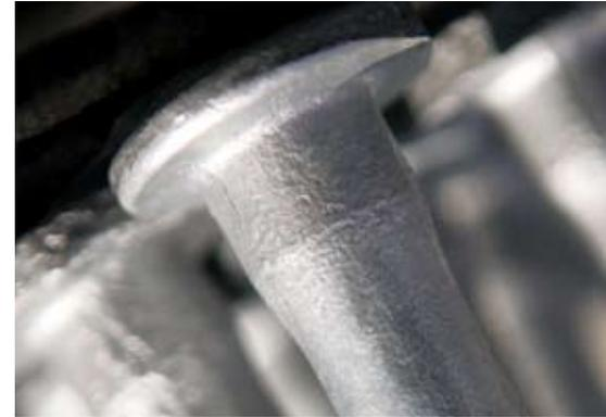
Los radios de transición grandes y la distribución uniforme de cargas en las cabezas de los tensores de la armadura se traducen en una concentración menor de esfuerzos y mayor durabilidad.
