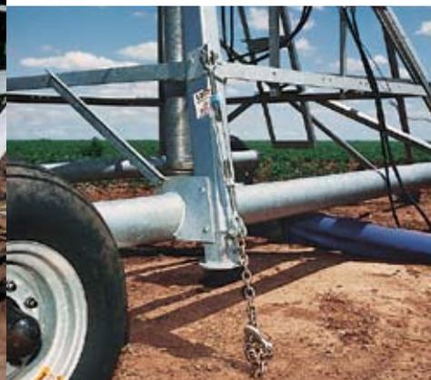
Los anclajes del pivote se fijan rápida y seguramente para usarse con anclajes de tierra o con plataforma de hormigón.
