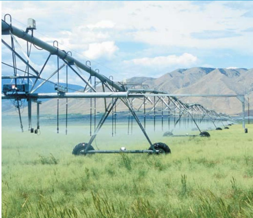
**Los equipos lineales ofrecen varios tipos de sistemas guía — con cable aéreo, por surco y con cable subterráneo. Los sistemas lineales Valley son unos de los equipos de riego mecanizado más duraderos y eficaces en el mundo para la conservación del agua.**
