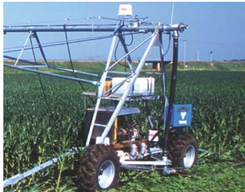
*Carro de 2 ruedas – alimentado con manguera y generador*
