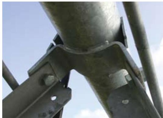
Los soportes con envoltura completa alrededor de la pata de apoyo en cada unidad propulsora proporcionan mayor resistencia. Los cartabones de unión de alta resistencia eliminan la torsión de la tubería.
