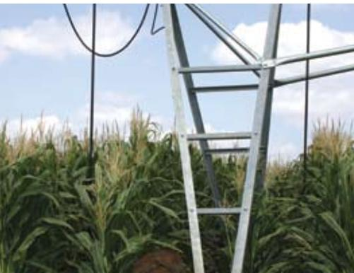
Un juego completo de cuatro riorstras en cada lado de la unidad propulsora asegura el funcionamiento estable en campos con terrenos accidentados.
