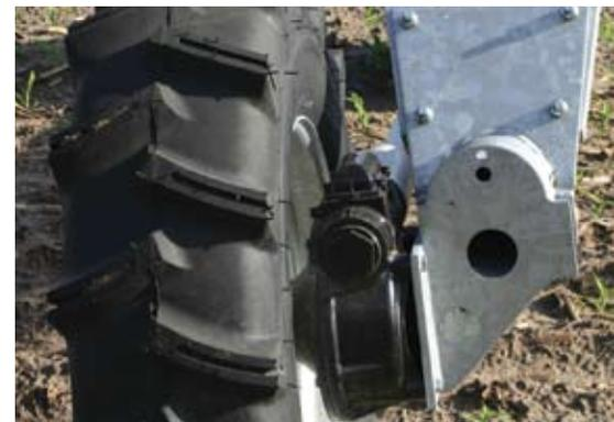
El eje de salida largo y la llanta descentrada proporcionan espacio libre entre la caja de engranajes y el neumático para reducir las acumulaciones de lodo y prolongar la vida útil de los retenes (sellos).
